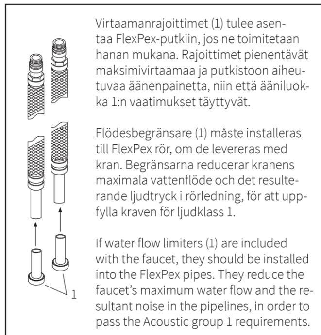
Virtaamanrajoittimet (1) tulee asentaa FlexPex-putkiin, jos ne toimitetaan hanan mukana. Rajoittimet pienentävät maksimivirtaamaa ja putkistoon aiheutuvaa äänenpainetta, niin että ääniluokka 1:n vaatimukset täyttyvät.
